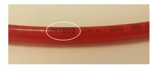
Una vez acabada la colocación del circuito, observar en el tubo la nueva longitud progresiva, y volver a apuntarla; la diferencia entre las marcas de longitud inicial y final determina la longitud real del circuito colocado (a verificarse con la de proyecto).
