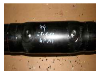
16. Colocar los parches sobre los tapones definitivos con ayuda de un soplete.
