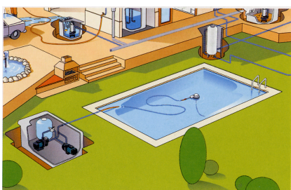
Recirculación y filtración del agua de piscinas
